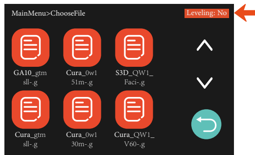
Heizbett nicht nivelliert
